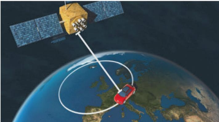
Zur eindeutigen Positionsbestimmung benötigt das Navigationssystem also die Signale eines zweiten und eines dritten Satelliten. Die drei Kreise bilden schließlich einen einzigen Schnittpunkt: Die Position des Fahrzeugs.
