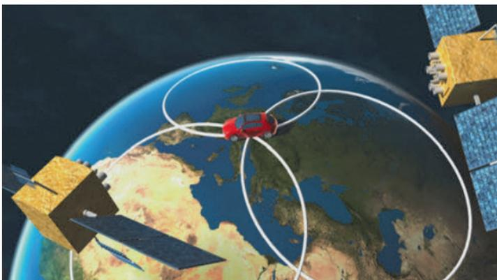
Die interne Uhr des Navigationssystems läuft nicht sehr exakt. Um dies auszugleichen, empfängt das Navigationssystem zusätzlich das Signal eines vierten Satelliten und erhält durch ihn einen Korrekturwert. So kann mithilfe von vier GPS-Satelliten aus einer Entfernung von 20.000 Kilometern die Position eines Fahrzeugs bis auf wenige Meter genau bestimmt werden.
