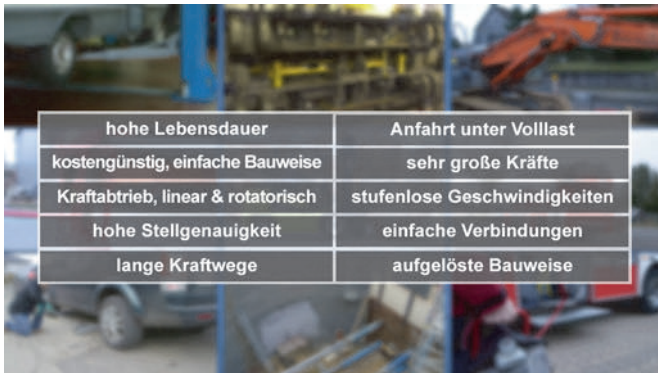
Abbildung 10: Prinzipielle Vorteile der Hydraulik
