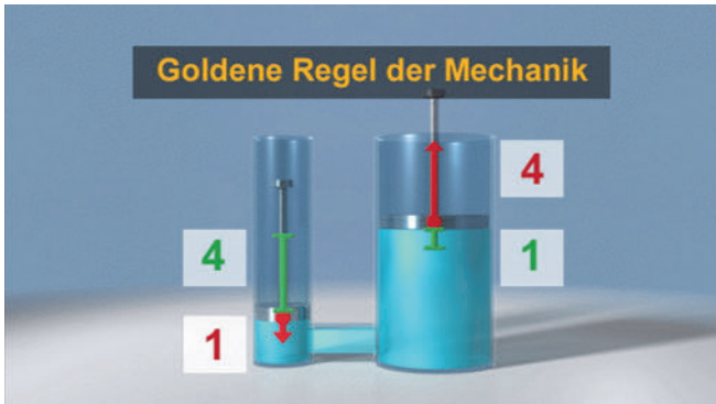
Abbildung 8: Die "Goldene Regel der Mechanik"
