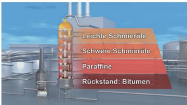
Beide Destillationsverfahren trennen das Kohlenwasserstoff-Gemisch des Erd- / Rohöls in sogenannte „Fraktionen“ auf, die aber mengenmäßig nicht zur Marktnachfrage passen. Es entstehen zu viel Schweröle und zu wenig leichte Kraftstoffe wie z.B. Benzin.
