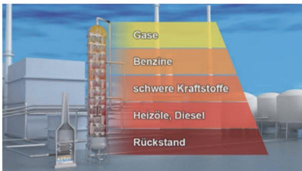
Der sogenannte „Rückstand“, der bei 400 °C noch flüssig bleibt, wird in einem zweiten Verfahren, der Vakuumdestillation, in seine Bestandteile aufgeteilt (Unterdruck senkt Siedetemperaturen).
