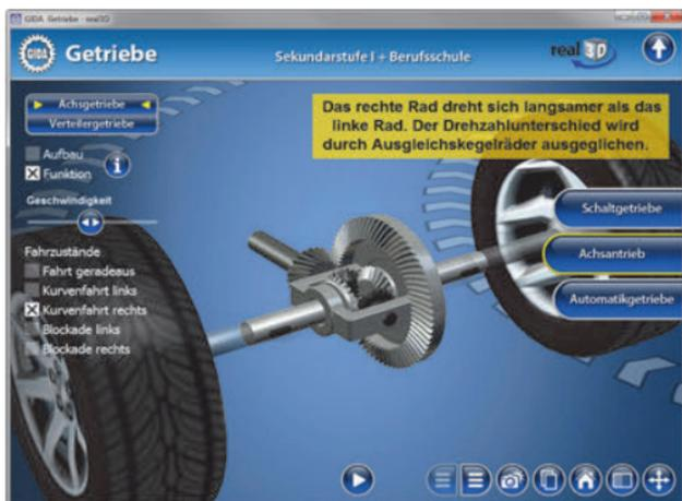
Der Teilbereich "Verteilergetriebe" verdeutlicht den Aufbau und die Funktion eines Verteilergetriebes. Im Bereich "Aufbau" können die verschiedenen Bauteile farblich markiert und ihre Bezeichnungen dem Modell zugeordnet werden. Alle Bauteile lassen sich gleichzeitig ein- und ausblenden.
